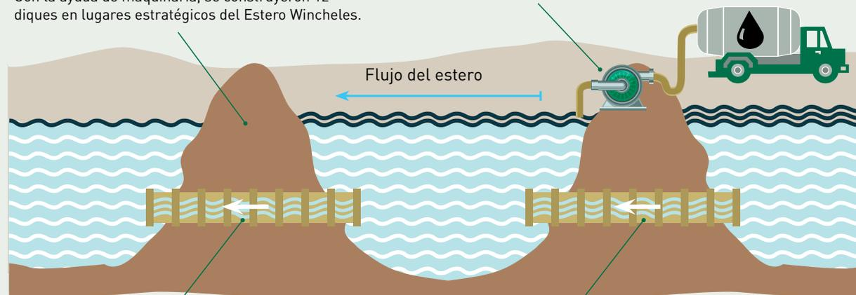
En el interior de los diques se instalan unas tuberías llamadas "cuellos de ganso" que permiten el flujo normal del agua del estero, de tal manera que el caudal no disminuye a pesar de los diques, mientras que el crudo flotante es retirado succionándolo de la superficie.
